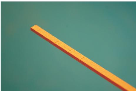
Vous obtenez alors, une baguette qui épousera plus facilement les différentes courbures de la coque, sans rompre au niveau des zones d'appuis formées par les couples de votre charpente.
